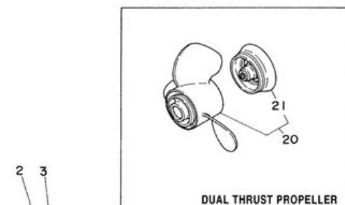
DUAL THRUST PROPELLER
