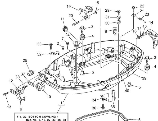
Fig. 20, BOTTOM COWLING 1
