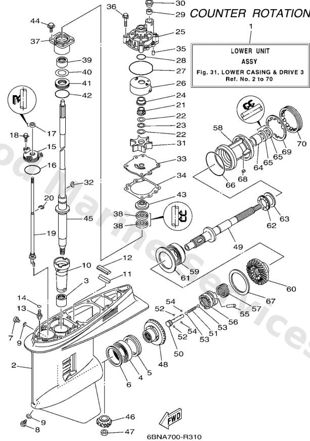
Fig. 31. LOWER CASING & DRIVE 3
